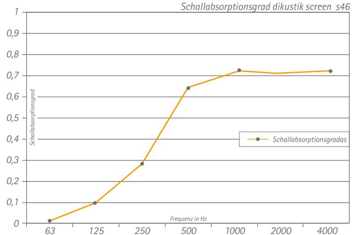
Der bewertete Schallabsorptionsgrad  $\alpha_w$  beträgt:  **$\alpha_w = 0,65$**
