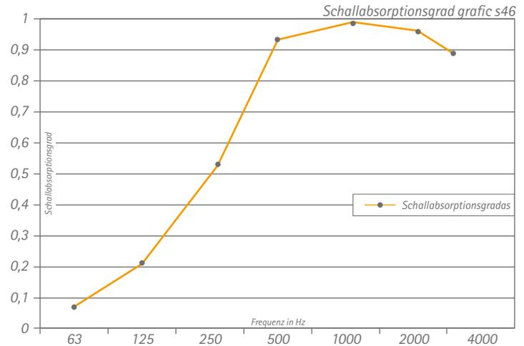
Der bewertete Schallabsorptionsgrad  $\alpha_w$  beträgt:  **$\alpha_w = 0,90$**
