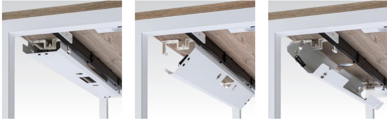
Zur einfacheren Bedienung ist der Kabelkanal beidseitig abklappbar und in 2 Höhen arretierbar. Links und rechts befinden sich Bohrungen zur Aufnahme einer Kabelkette. Für den problemlosen Einbau einer 3-fach-Steckdose ab 1200 mm Kabelkanallänge ist mittig ein Ausschnitt vorhanden. Der beidseitig klappbare Kabelkanal ist verwendbar an Schreibtischen mit fester Tischplatte und an Schreibtischen mit Schiebepplattenfunktion (optional wählbar).
